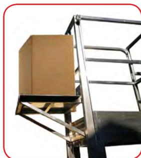
Scala doppia a gradini ad un tronco di salita provvista di piattaforma, guardacorpo e corrimani. È in alluminio estruso nervato saldato. La scala è dotata di pianetto in alluminio elevabile ad argano manuale per consentire la salita e la discesa di cartoni, confezioni ed oggetti durante le operazioni di picking (presa dagli scaffali) nei magazzini e nei supermercati. Lo schienale è perpendicolare al terreno in modo da permettere all'operatore di avvicinarsi frontalmente allo scaffale.
