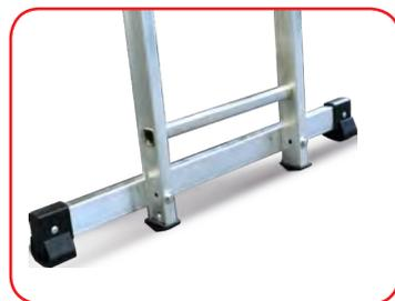
**Allargatore di base in dotazione** (smontabile per il trasporto o il rimessaggio della scala) - Le scale oltre ai m 3 sono utilizzabili in conformità alla norma EN131 solo con l'applicazione dell'allargatore. Senza detta applicazione le scale sono conformi solamente al D.Lgs.81/2008.
