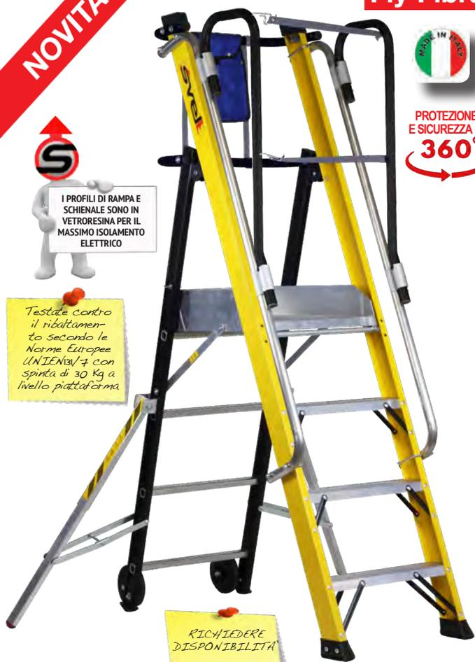
Scala professionale isolata elettricamente progettata per gli operatori che si trovano a lavorare in prossimità di cavi, prese o altre fonti di energia elettrica. I montanti in fibra di vetro offrono isolamento elettrico e i gradini zigrinati antiscivolo in alluminio conferiscono alla scala leggerezza e maneggevolezza. E' conforme alle Norme Europee UNI EN 131/7.
