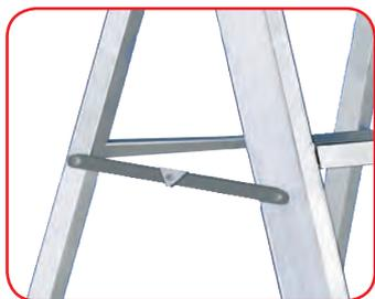
Barre anti chiusura/apertura in acciaio zincato. Oltre ad evitare l'apertura o la chiusura accidentale irrobustiscono la scala nella parte centrale. Ideali per uso industriale dove le cinghie anti apertura si danneggiano più facilmente.
