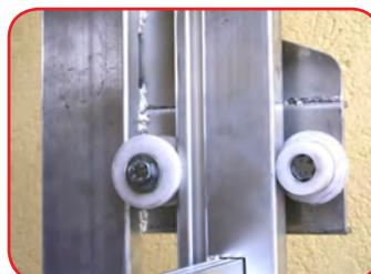
Cilindri di scorrimento in teflon
