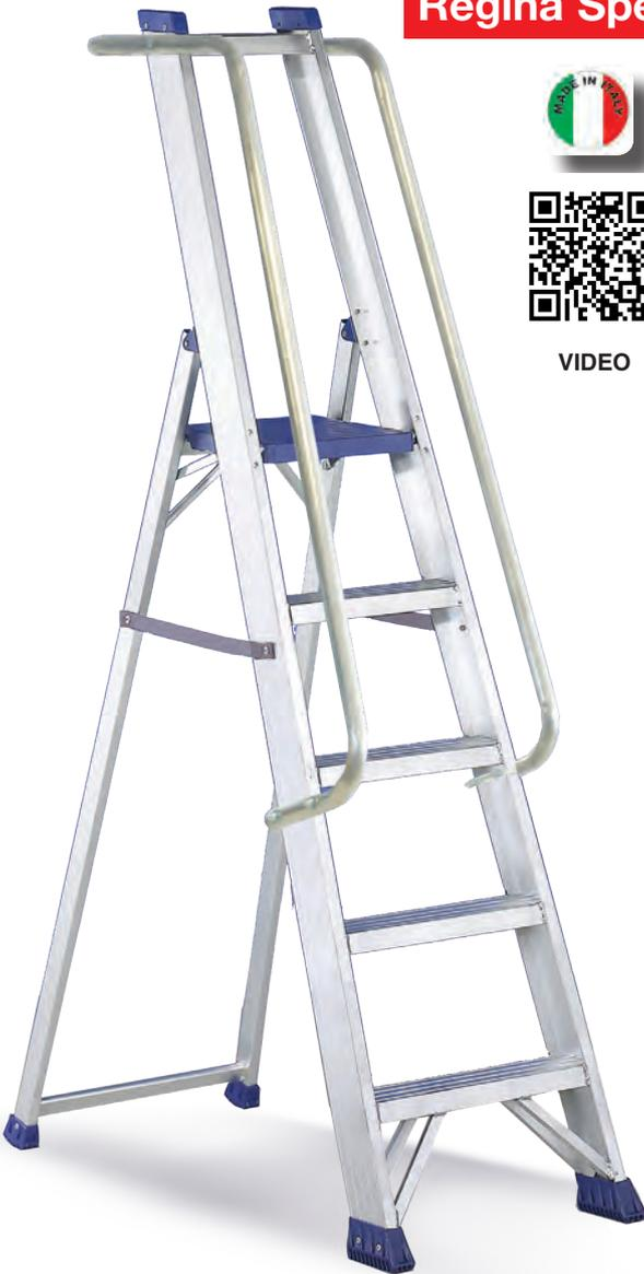
Scala doppia a gradini ad un tronco di salita provvista di piattaforma, guarda-corpo e corrimano. Ideale per utilizzo professionale leggero. In alluminio estruso nervato é costruita saldando i gradini ai montanti ottenendo un monolito ultraresistente.
